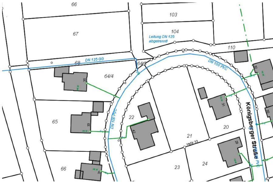
Abb. 4: Auszug aus Bestandsplan „Wasserversorgungsleitung“
