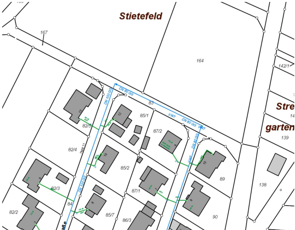
Abb. 2: Auszug aus Bestandsplan „Wasserversorgungsleitung“
