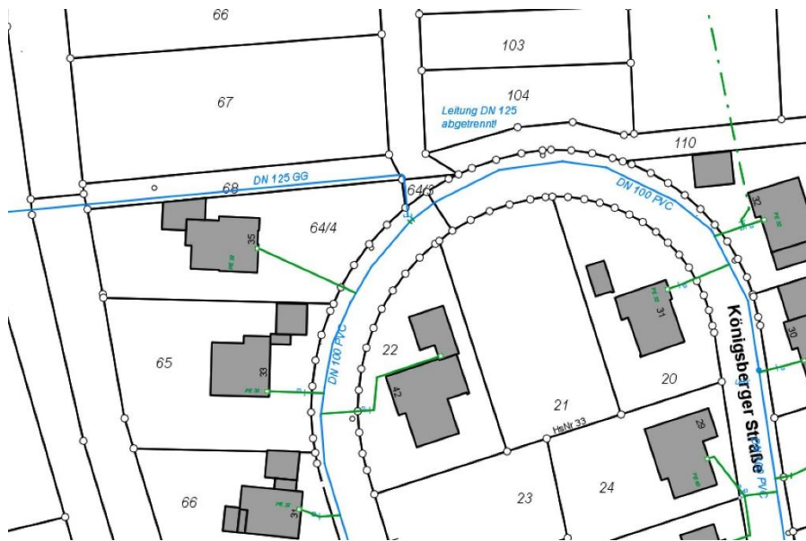
Abb. 1: Auszug aus Bestandsplan „Wasserversorgungsleitung“
